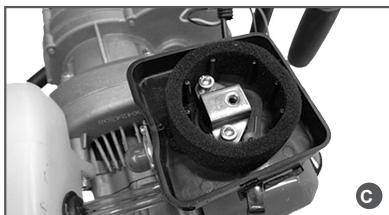
Рис. 11 Обслуживание воздушного фильтра
