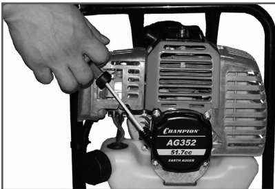
Рис. 7 Свободный ход шнура стартера
