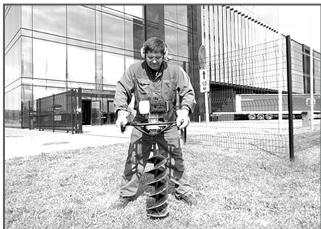
Рис. 8 Положение тела оператора при работе мотобуром
