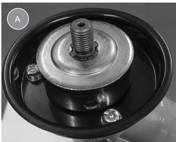
Установите на редуктор защитную шайбу и шайбу крепления ножа (Рис.6А). Накрутите на вал редуктора триммерную головку. Совместите отверстие в чашке редуктора и защитной шайбе ножа. Установите в отверстие металлический стопор и затяните триммерную головку (Рис.6С).
