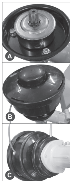
Рис. 6 Установка триммерной головки
