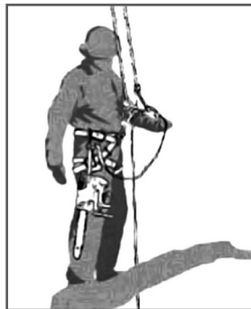
Рис. 19 Пример крепления пилы к ремню оператора
