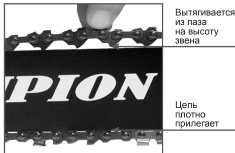
Рис. 5 Регулировка натяжения цепи
