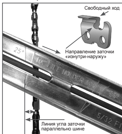
Рис. 28 Определение угла заточки
