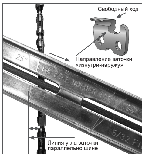
Рис. 22 Расположение линии угла заточки
