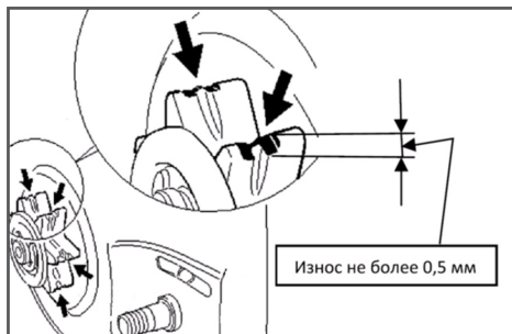
Рис. 14 Проверка износа звездочки
