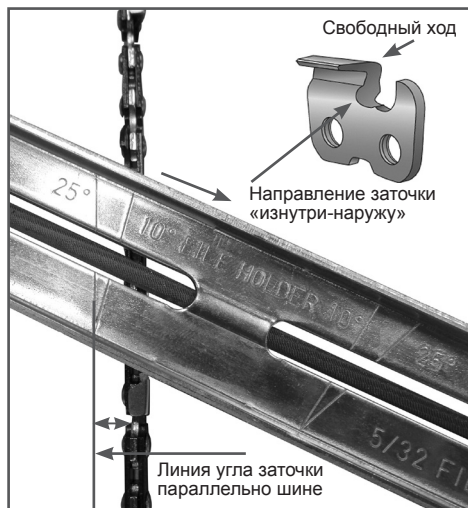
Рис. 16 Определение угла заточки
