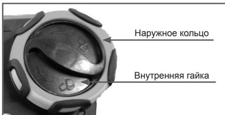
Рис.2 Регулятор натяжения цепи
