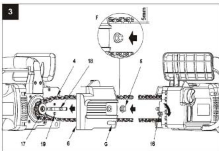
2. Поворачивая болт(16), установите палец натяжения цепи(19) в крайнее левое положение;
