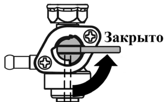
Рис. 12 Топливный кран закрыт
