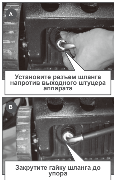
Рис. 4 Подключение шланга высокого давления к аппарату
