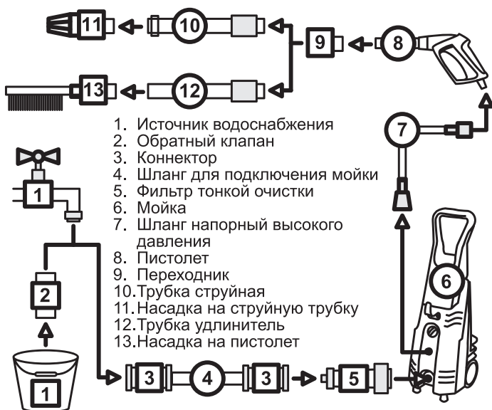
Рис. 13 Схема подключения аппарата с дополнительным оборудованием
