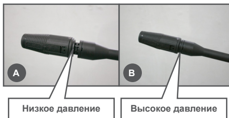
Рис. 12 Положения головки струйной трубки
