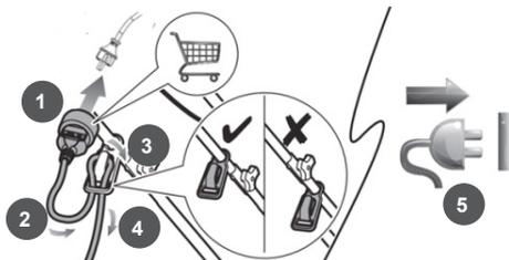
Рис. 8 Фиксация кабеля удлинителя на рабочей рукоятке.
