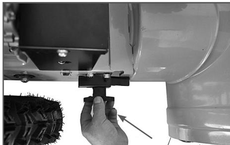
Рис. 10 Закрепление снегоотбрасывателя
