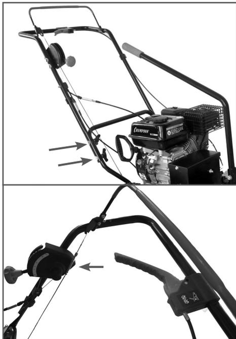
Рис. 2 Установка рукоятки
