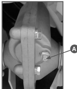
Рис. 25 Расположение пресс-масленки на редукторе
