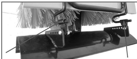
Рис. 5 Установка отвала на кронштейны щетки
