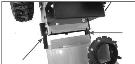
Рис. 8 Установка снегоотбрасывателя
