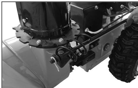
Рис. 12 Установка нижней части рычага поворота желоба
