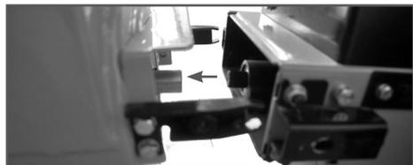
Рис. 9 Центровка валов отбора мощности и снегоотбрасывателя
