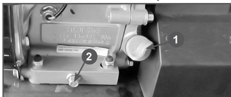
Рис.19 Замена моторного масла
