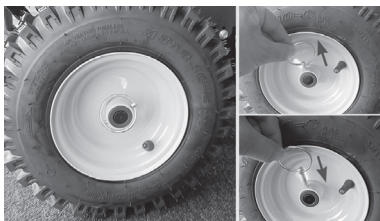
Рис.17 Установка шплинта на левом колесе
