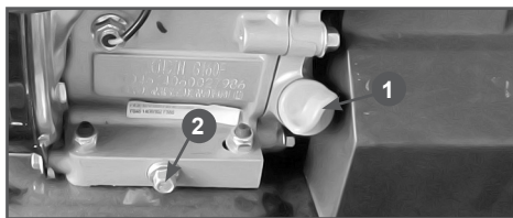
Рис.28 Замена моторного масла
