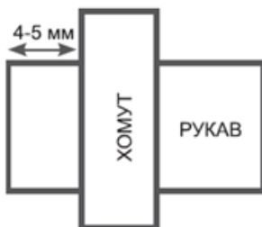
Рис. 6 Расположение хомута на рукаве
