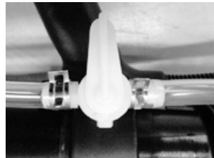
Рис. 8 Установка выпускного шланга на штуцер запорного крана
