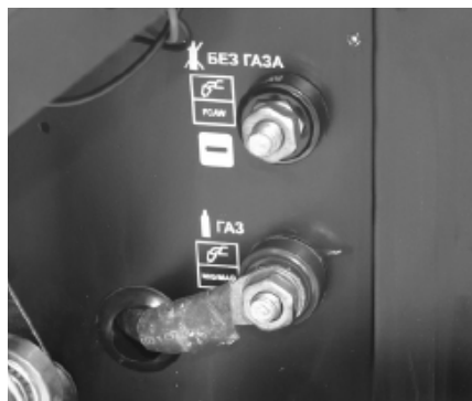
Рис. 9 Клеммы подключения кабеля механизма подачи проволоки
