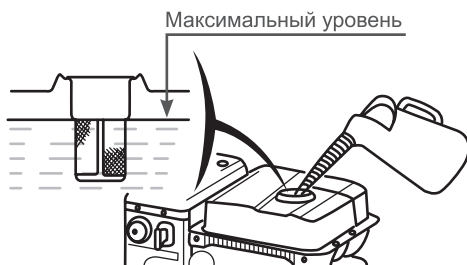
Рис. 8 Максимальный уровень топлива в топливном баке
