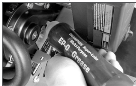
Рис. 22 Добавление смазки в редуктор
