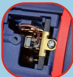
Латунные щеткодержатели за счет высокой теплопроводности материала обеспечивают надежную работу инструмента.
