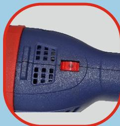
Регулятор скорости изменяет частоту вращения рабочего инструмента во время работы.
