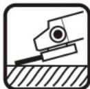
• При шлифовке и зачистке угол наклона машины по отношению к обрабатываемой поверхности может меняться от 15° до 30° (для грубой обработки ближе к 30°, при чистовой ближе к 15°).
